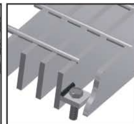
FIJACIÓN CON PLACA. SOLDADA. SIN ESCALA
